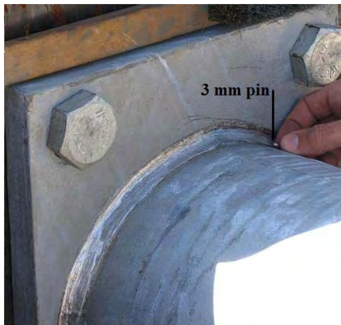
Figure 15 Measurement of UIT Application Groove by Rolling a 3 mm Diameter Pin from the UIT Tool in the UIT Application Groove
