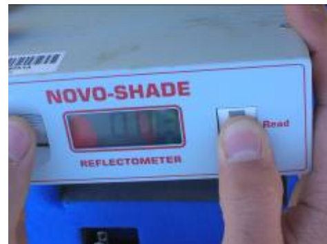
(d) Calibration of 0 percent reflectance
